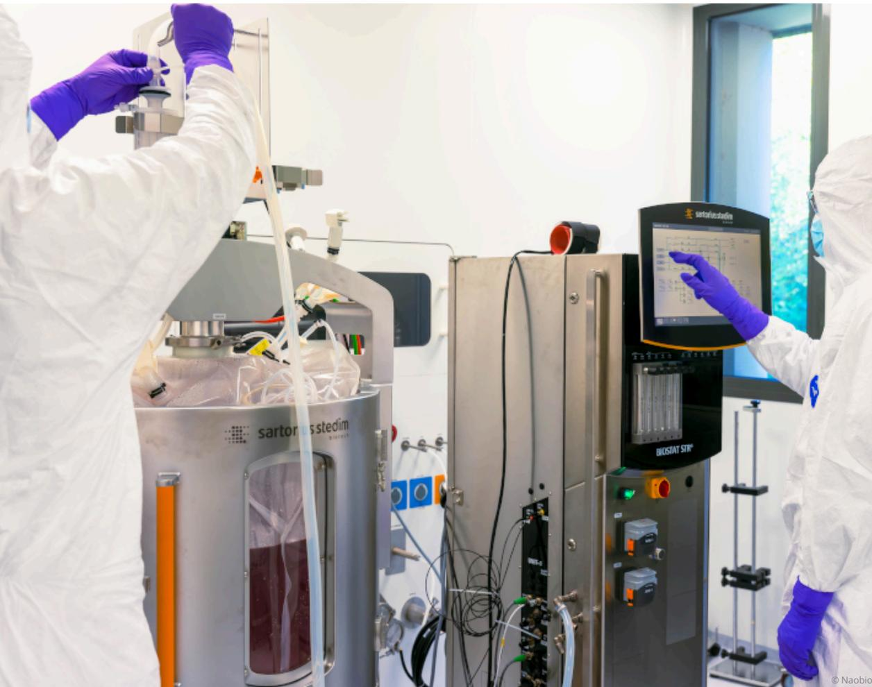
En moins de six mois, le développement de cycles et la QP de ce laboratoire BSL-3 de biotechnologies ont permis de valider un protocole de DSVa avec **6 log<sub>10</sub> de désinfection (IB) et 4 log<sub>10</sub> (coupons viraux MVM)**, pour la zone et le PSM en sorbonne qui lui est lié (6 log<sub>10</sub> dans l'enceinte de travail de classe A, 5 log<sub>10</sub> atteint dans le plénum technique). Les équipes de cette zone de production ont gagné notamment :
