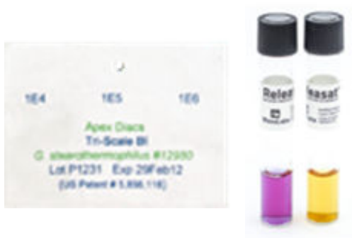
Figure 3 : enveloppe d'indicateurs biologiques avec trois coupons de spores de Geobacillus stearothermophilus avec des populations de 4 log 10 , 5 log 10 , 6 log 10 . A droite, des tubes de bouillon de culture après 7 jours d'incubation à 55-60°C : en violet, aucune croissance bactérienne, en jaune, croissance bactérienne (témoin positif).
