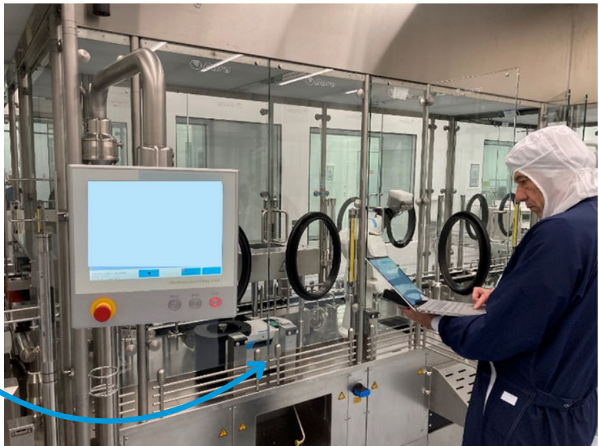
Photo 2 : vue du RABS portes fermées
