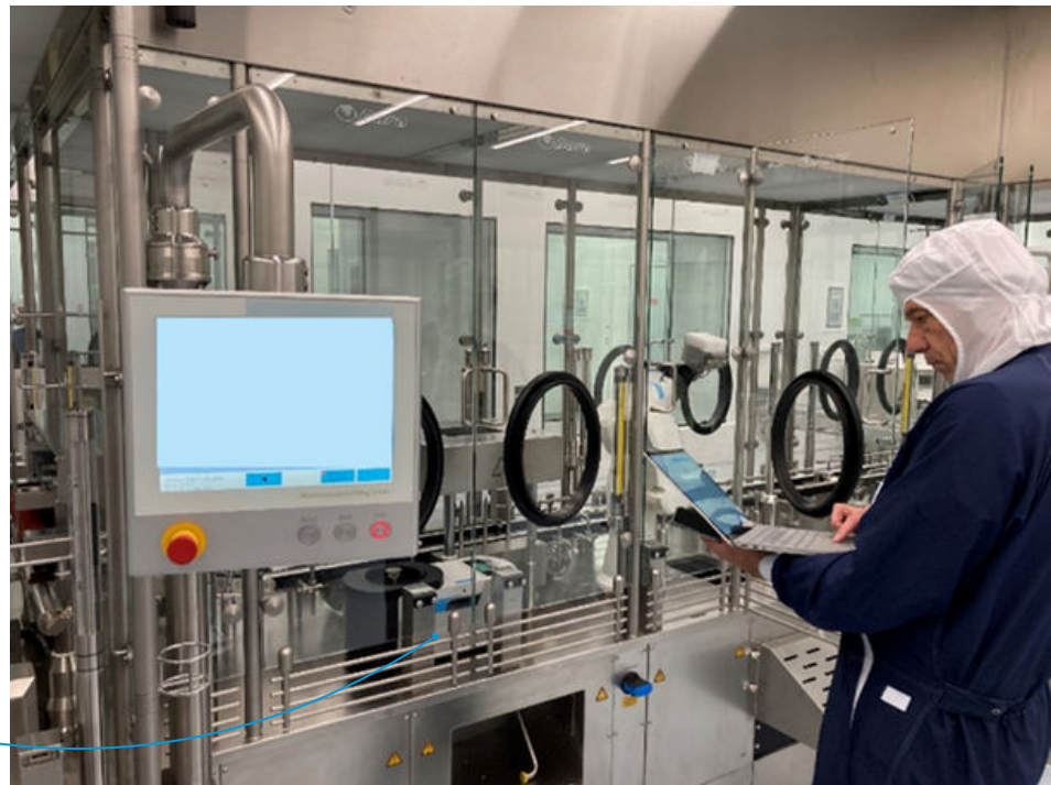
Foto 2: Ansicht des RABS bei geschlossenen Türen
