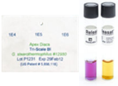
Abbildung 3: Umschlag mit biologischen Indikatoren mit drei Sporenproben von Geobacillus stearothermophilus mit Populationen von 4 log 10 , 5 log 10 , 6 log 10 . Rechts: Bouillonröhrchen nach 7 Tagen Inkubation bei 55-60 °C: violett = kein Bakterienwachstum, gelb = Bakterienwachstum (positive Kontrolle).
